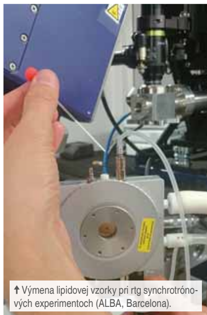
↑ Časť výskumu na katedre vykonávame na zahraničných pracoviskách. Detail časti experimentálneho zariadenia pre malouhlovú rtg difrakciu na BL11 – NCD lúči synchrotrónu ALBA, Barcelona.
